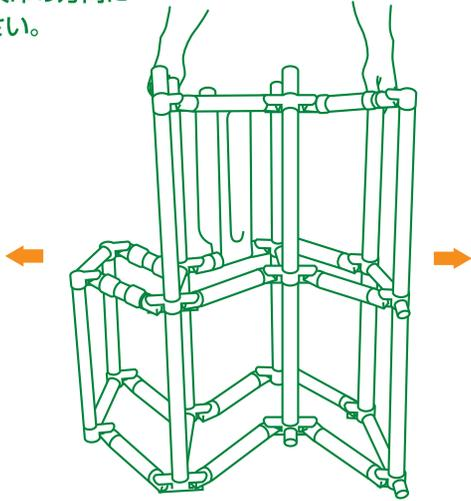
**2** ジョイントロック(8ヶ所)を手で矢印の方向に回しながらスライドさせ、ジョイント接続部分をカバーしてください。
