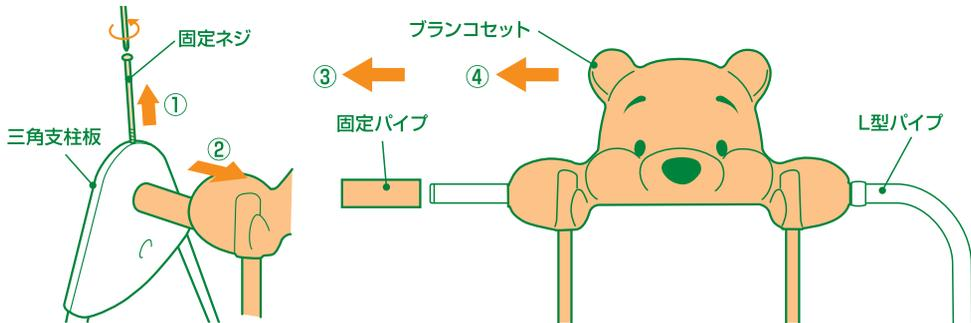
**3** 高さ調整ネジの高さ位置を変えると鉄棒の高さを変更出来ます。
