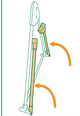
**5** ジョイントロックを図のようにスライドしてすべて外してください。(16ヶ所)
