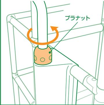
**2** 三角支柱板から①固定ネジをプラスドライバーでゆるめて引き抜いてください。次に 三角支柱板から②L型パイプを抜いて、③固定パイプ、④プランコセットも引き抜いてください。
