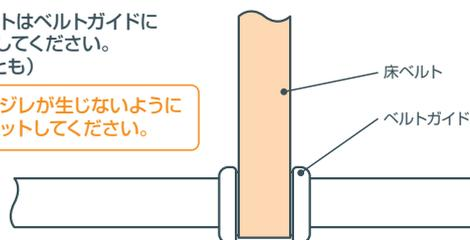
床ベルトの先端を図のように器具に通してください。
