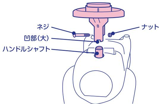
ハンドルの筒の凹部の大きい方を前向きにしてハンドルシャフトに差し込み、ビス穴にネジを通してナットで強く締め付けてください。
