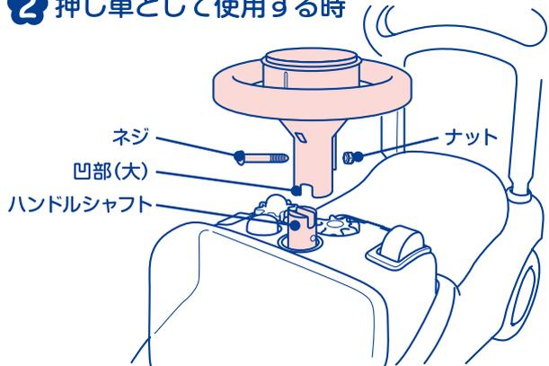
ハンドルの筒の凹部の大きい方を前向きにしてハンドルシャフトに差し込み、ビス穴にネジを通しナットで強く締め付けてください。
