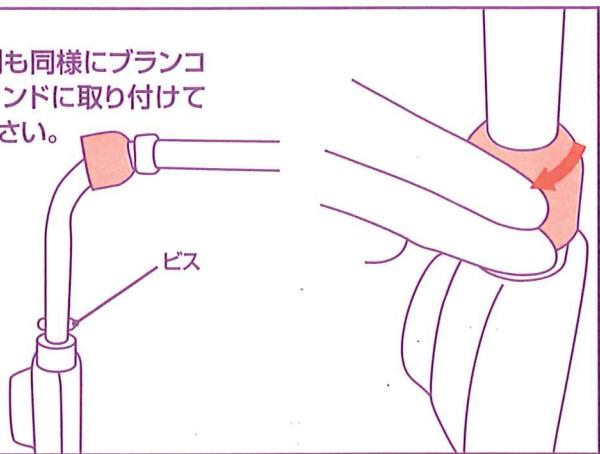
10 ブランコスタンドの下のプラナットを矢印の方向に回して締めてください(2ヶ所)。
