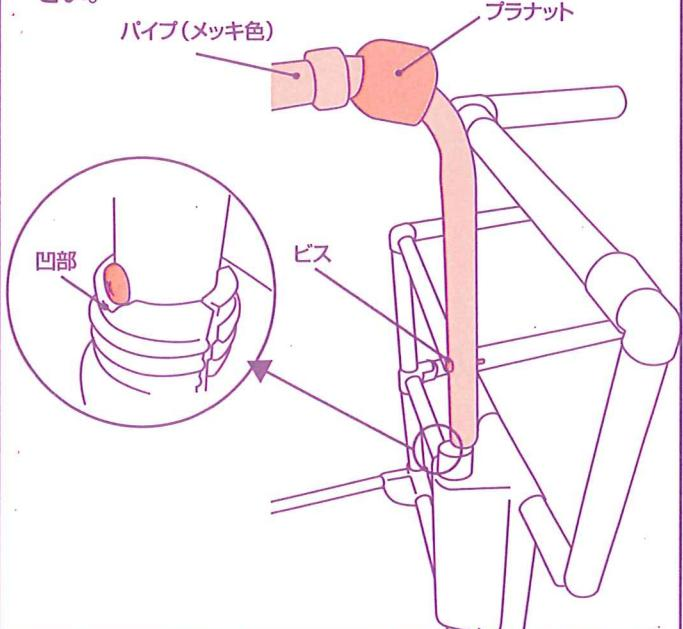
8 プラナットを矢印の方向に回し締め付けてください。
