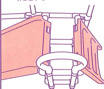
ステップパネルを「すべり面」「階段」の穴に合わせてハメ込み、セットしてください。
