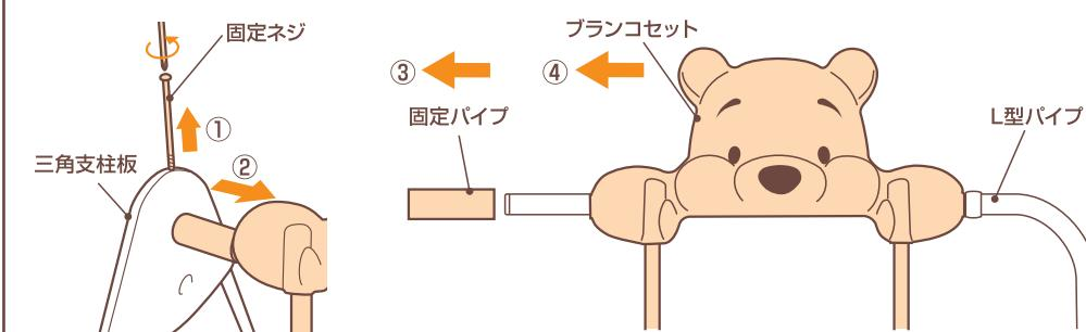
**3** ①L型パイプを取り外すために、一度上段接続パイプセットを取り外してください。
