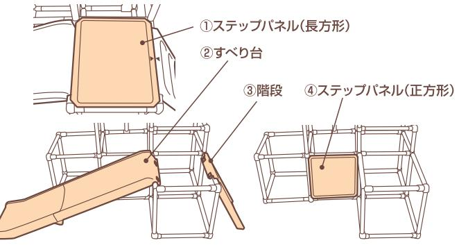
**7** ジョイントロックを図のようにスライドしてすべて外してください。(12ヶ所)
