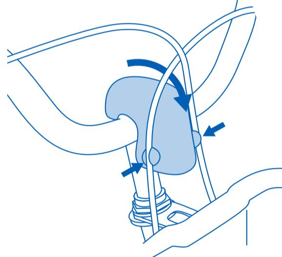
押手棒を差し込み、高さ調整穴にピンが出るようにセットしてください。
