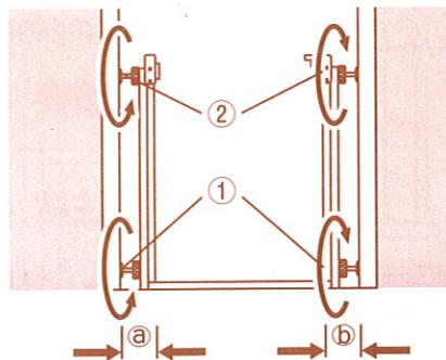
ナットの締め付け方向はシールで4ヶ所に表示しています。
