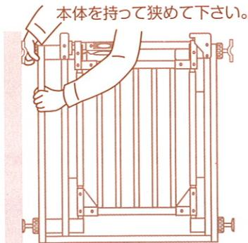
●本体を支えながら下部①の取り付けナットを矢印方向に回し、締め付けてから上部②を矢印方向に締めてください。
