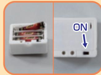
④ チャイムの電池ふたを開けて単4乾電池3本を入れて下さい。スイッチを「ON」にしてチャイム音が鳴る事を確認して下さい。 ※単4乾電池3本は別売りです。
