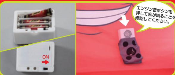
⑥ ICボックス裏側電池ぶたのネジを外し、単4乾電池3本(別売)を正しい向きに入れ、ふたをしてネジで固定してください。スイッチを「ON」にして、ICポケットに入れてください。
