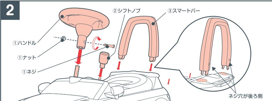
①本体を表に向けて先ほど差し込んだハンドルパイプにハンドルをセットして、ネジとナットで取付けてください。
