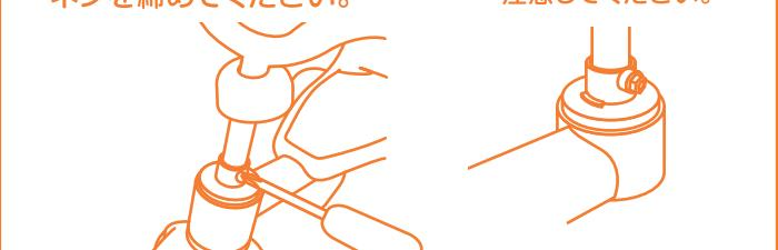
④ ネジを締めましたらハンドルカバー2ヶ所の合わせマークをカバー受けの穴位置に合わせ、上からハンドルカバーを押して取り付けてください。
