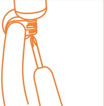
② カジキリ押手棒下側の化粧ネジを外し、上側パイプの凹みを前に向けて差し込んでください。
