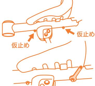
※必ず前後の2ヶ所にスプリングワッシャーと袋ナットを手で取り付けてから板スパナで固定してください。
