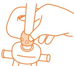
④ 外した化粧ネジを下側に出た押手棒(下)のネジ部に取り付け、締めてください。
