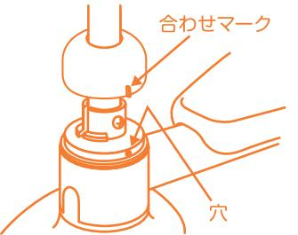
⑤ サイクルベルを締め付けます。サイクルベルはベルの下側からプラスドライバーで締めてください。
