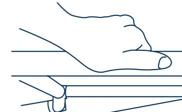
2 パイプに指をはさまないようパイプを持った時にパイプを手で巻き込むように、にぎらず、右図のように持って、たたんでください。
