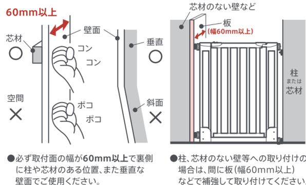
**注意** 取り付け場所の壁面が弱い場合、壁面がたわんだり、へこんだり、突き破ったりする恐れがあります。裏側に柱や補強材のある壁面に設置してください。
