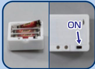
④ ICボックスの電池ぶたを開けて単4乾電池3本を入れて下さい。スイッチを「ON」にしてチャイム音が鳴る事を確認して下さい。
