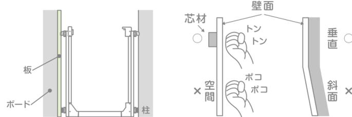
●柱のない壁等への取り付けの場合は、間に板などで補強して取り付けてください。
