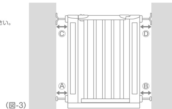
**4** (C)(D) の上部のナットを本体と扉(ロック部)の隙間が(図-4参照)約1mm位になるようにナットを締めてください。
