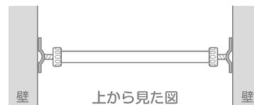
●ツーポイントアジャスターは、上部に縦・横どちら向きにも使用できます。図のように使用することにより、一段と強くすれにくくなります。
