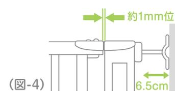
**警告** ・アジャスター(A)(B)(C)(D)(図-3参照)が左右均等でないと本製品がはずれたり、破損する恐れがありますので、左右均等になるように締め込んでください。
