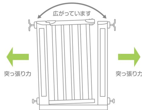
本製品は突っ張り力を使用して壁面等に設置する構造のため、本体上側の幅が下側より広く設計されています。
