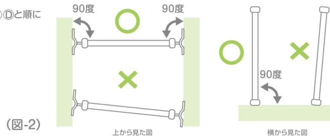
**3** (A)(B) 下部のナットをしっかり締めて固定してください。
