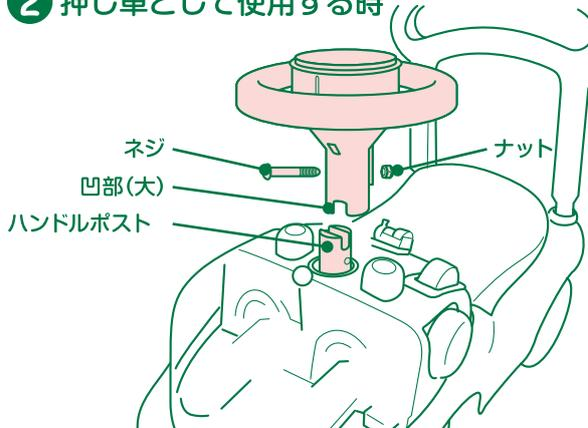
ハンドルの筒の凹部の大きい方を前向きにしてハンドルポストに差し込み、ビス穴にネジを通しナットで強く締め付けてください。
