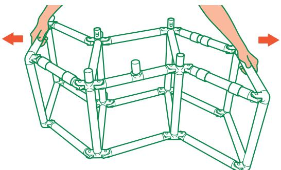
2 ジョイントロック(6ヶ所)を手で矢印の方向に回しながらスライドさせ、ジョイント接続部分をカバーしてください。
