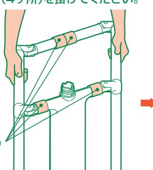
6 ⑤で完成した上段接続パイプセットをジム本体に接続してください。
