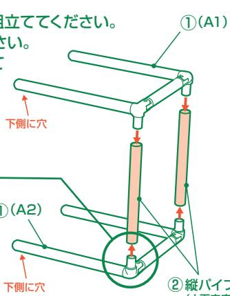
4 ③で組立てた下段接続パイプセット(A)をパイプのⒶマークシールを確認して本体下段に接続してください。
