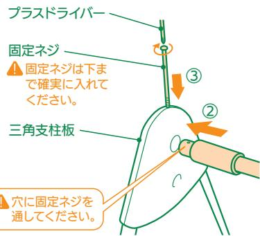
17 プランコ座席のつり棒上部に、プランコパネルを差し込み、ネジをプラスドライバーで締めてください。(左右2ヶ所)
